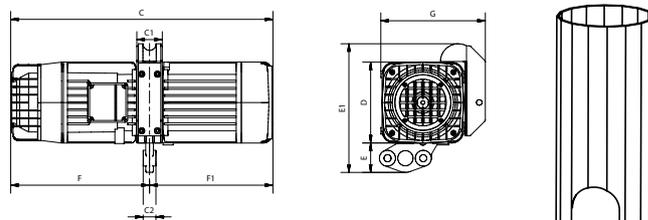
Adaptés à être incorporés dans des poteaux métalliques, ils permettent, grâce à un retour à chaîne spécial, de relever et d'abaisser une couronne mobile avec des phares le long du poteau pour le montage et la maintenance. Pour assurer un fonctionnement optimal, le palan est monté en position inversée par rapport aux applications standard.
